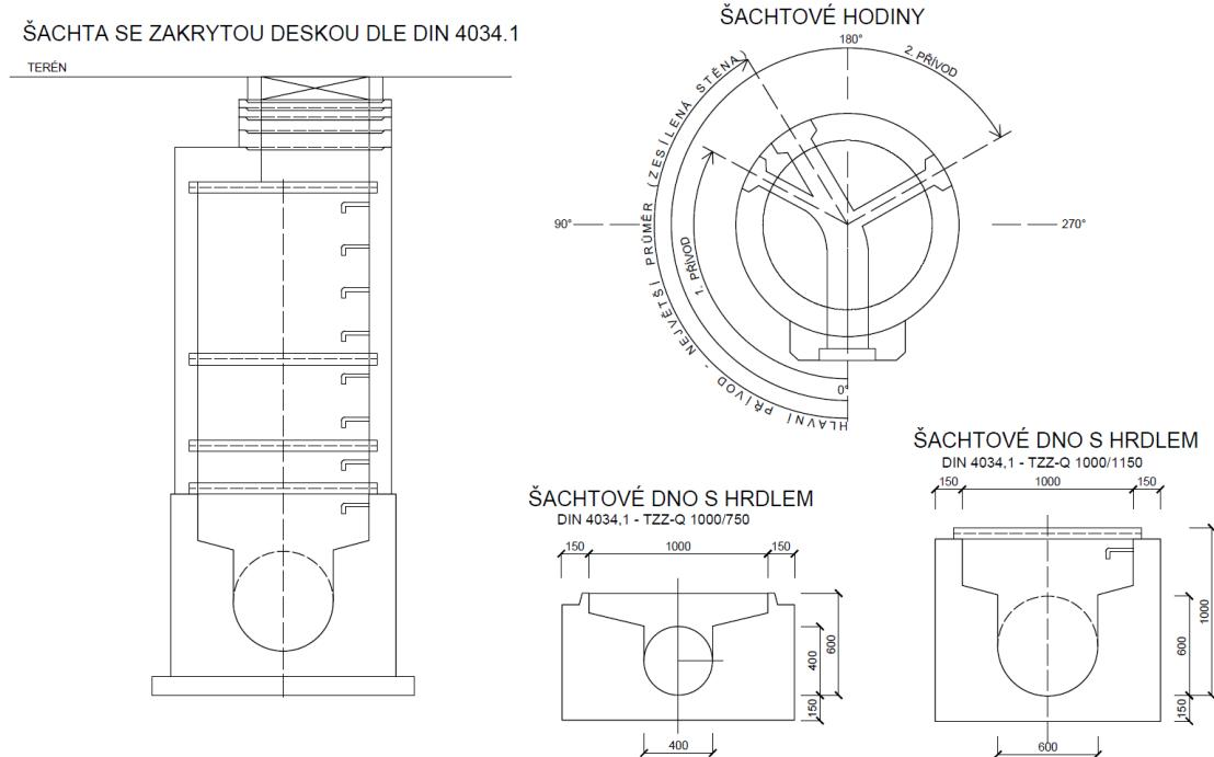
K7 – Vzorový výkres stupadel v kanalizační šachtě dle DIN 4034.1
